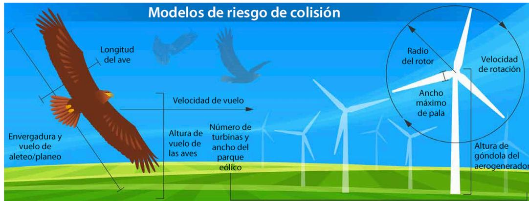
Figura 4. Parámetros que se utilizan a menudo en los modelos de riesgo de colisión. Gráfico del Laboratorio Nacional de Energías Renovables;
