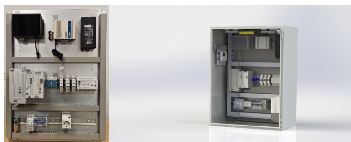
Fig.4. Montaje del cuadro con elementos
